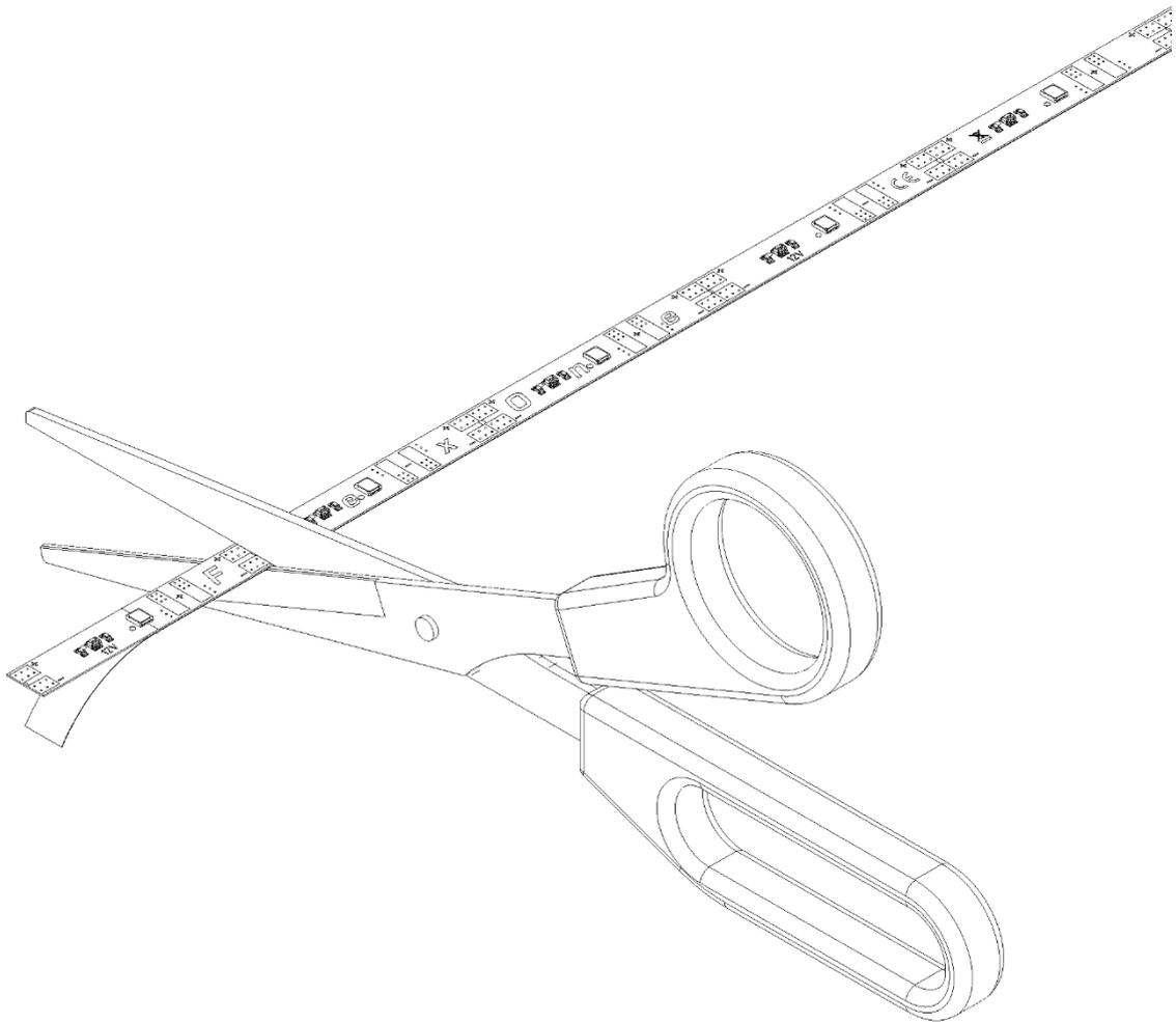
Die FlexOne100 Performer 12V LED Leisten können alle 50 mm getrennt bzw. gekürzt werden. Auf der Rückseite der LED Leiste befindet sich ein doppelseitiges wärmeleitendes Klebeband, wodurch eine einfache und schnelle Montage der LED Leiste möglich ist. Dadurch können Sie nahezu alle Flächen und Formen direkt oder indirekt beleuchten. Zum Kürzen der FlexOne100 Performer 12V LED Leisten kann eine Schere verwendet werden.
