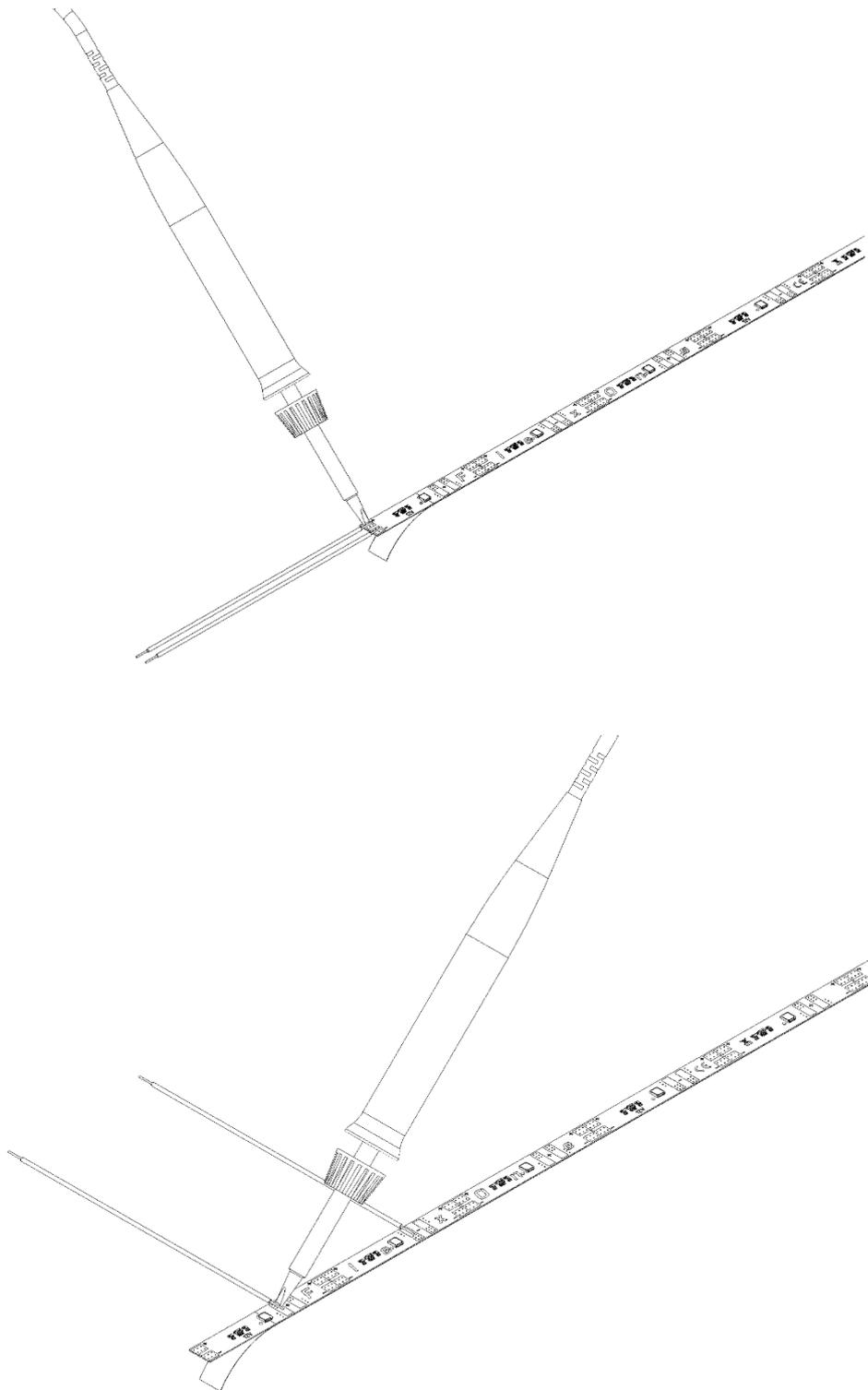
Der Anschluss der FlexOne100 Performer 12V LED Module erfolgt über eine Lötverbindung an den dafür vorgesehenen Anschlusspads.
