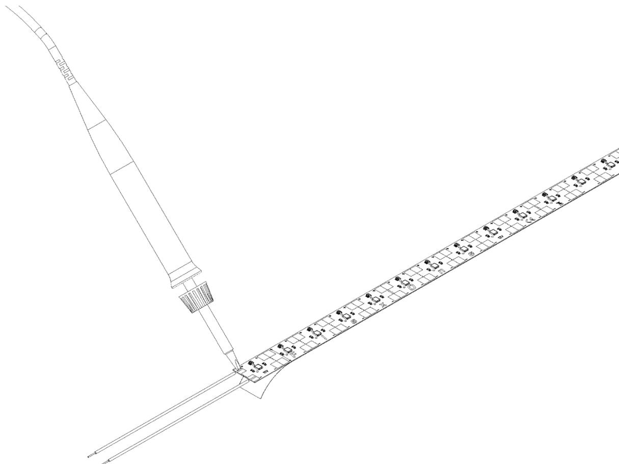
Der Anschluss der FlexOne 250 Performer 12V LED Module erfolgt über eine Lötverbindung an den dafür vorgesehenen Anschluss pads.
