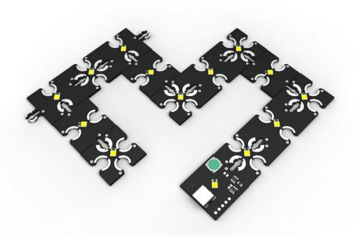
Über den Taster auf dem Einspeisemodul können die Module mit einem kurzen Tastendruck (<1 Sekunde) ein- bzw. ausgeschalten werden.
