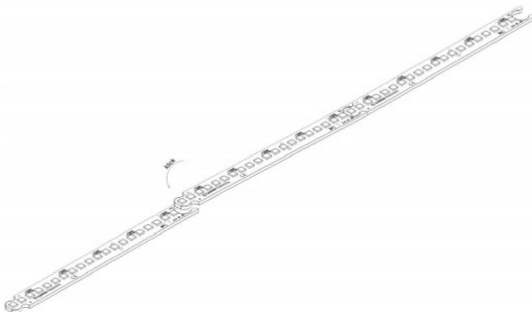
Mit dem patentierten LUMITRONIX Verbindungssystem Conext, können die verschiedensten Modulängen realisiert werden.
