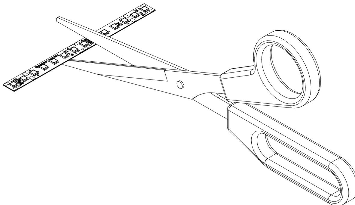
Die LumiFlex 350 Pro LED Leisten können alle 100 mm getrennt bzw. gekürzt werden.
