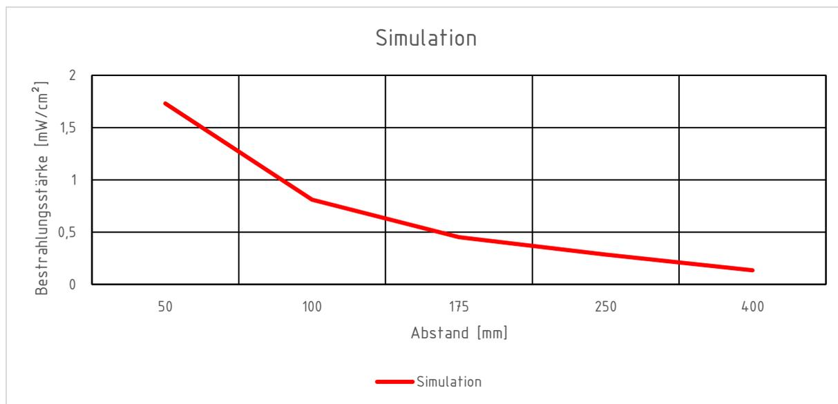
Simulation der Oberflächenbestrahlungsstärke mit einem Abstand von 100 mm von LEDiL:
