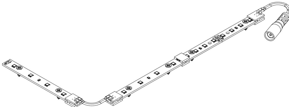
Mit den Direktverbindern und den Kabelverbinder ist eine unkomplizierte, verpolungssichere Verbindung mehrerer MultiBar LED Leisten möglich.
