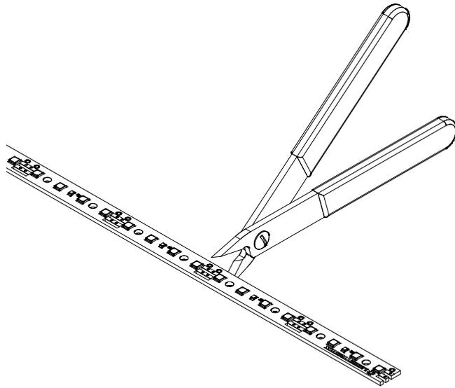
Zum Kürzen der LED Leisten wird ein Seitenschneider empfohlen.
